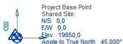
Figuur 52: Revit - Project Base Point
