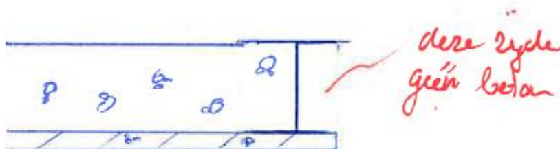
Figuur 117: Uitzondering I-profiel als randbalk
